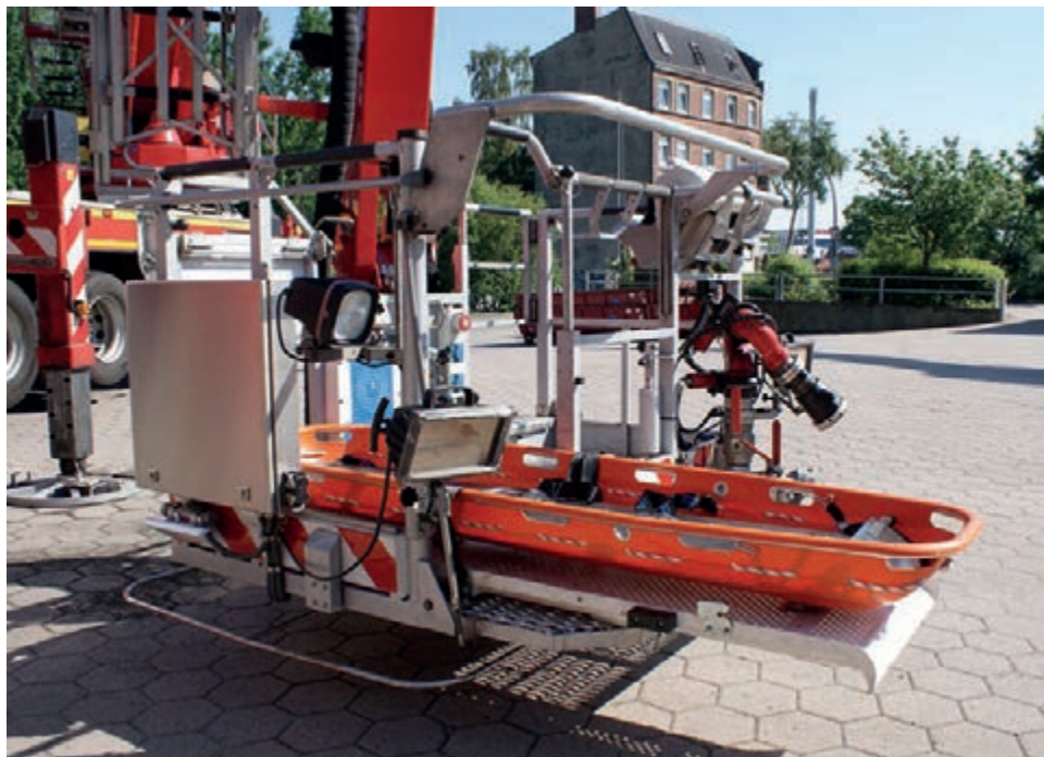
Bild 4 Hubarbeitsbühne mit Krankentragenlagerung (KTL)
