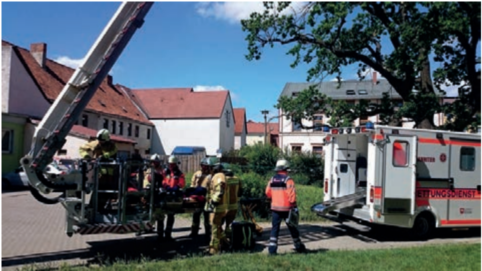
Bild 8 Hubarbeitsbühne mit KTL und Patientenlagerung auf dem Korbboden
