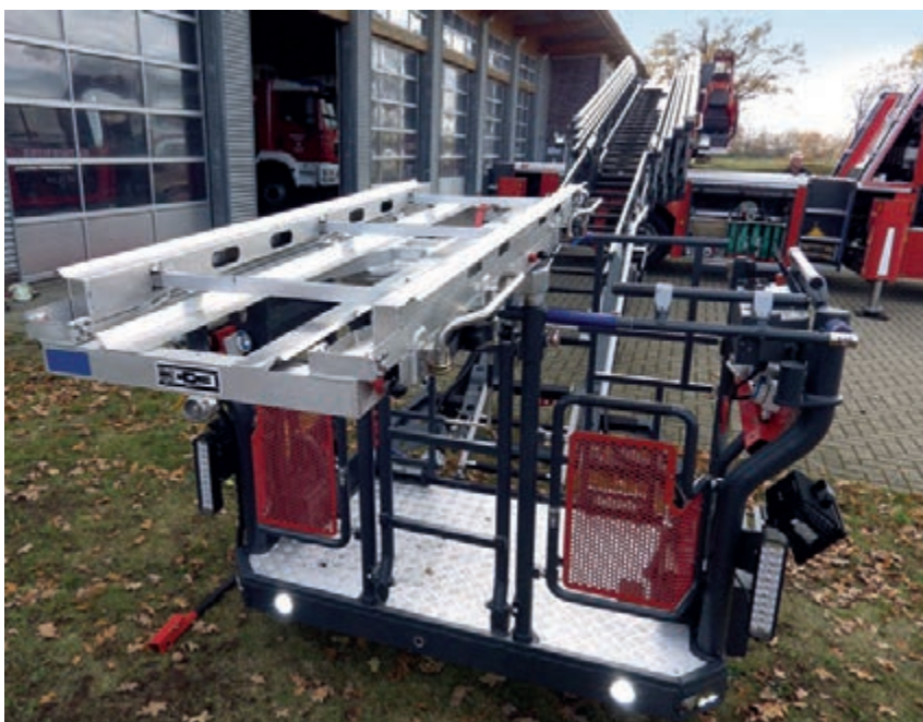
Bilder 5 a und b DLAK 23/12 (Rosenbauer) mit Rettungskorb und KTL
