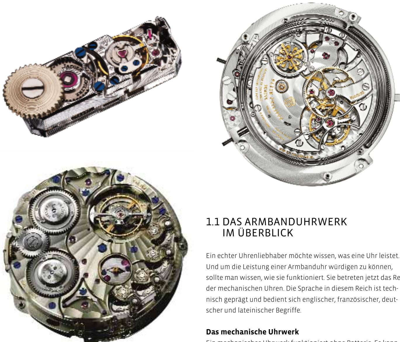
**OBEN:** Das Jaeger-LeCoultre 101 ist das kleinste mechanische Uhrwerk der Welt und besteht aus lediglich 98 Einzelteilen. © 2016 Jaeger-LeCoultre
