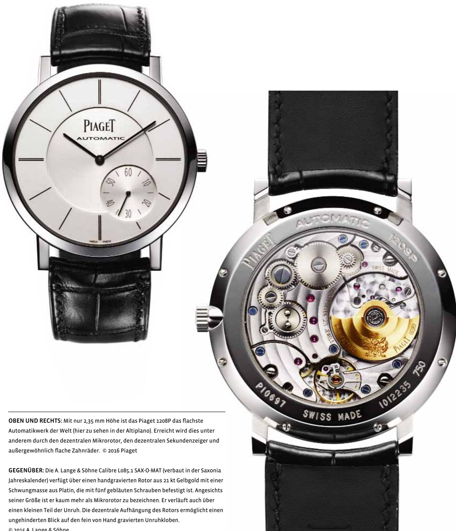
**OBEN UND RECHTS:** Mit nur 2,35 mm Höhe ist das Piaget 1208P das flachste Automatikwerk der Welt (hier zu sehen in der Altiplano). Erreicht wird dies unter anderem durch den dezentralen Mikrorotor, den dezentralen Sekundenzeiger und außergewöhnlich flache Zahnräder. © 2016 Piaget
