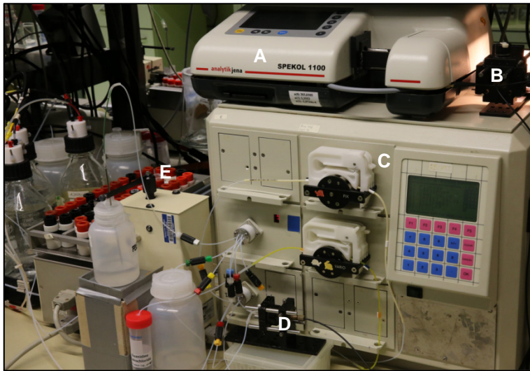
Bild 3.4 Messplatz mit Rlfs-Setup: Spektrometer (A), Weißlichtquelle (B), ASIA-Fluidik (C), Flusszellenhalterung (D) und Autosampler mit Injektornadel (E)
