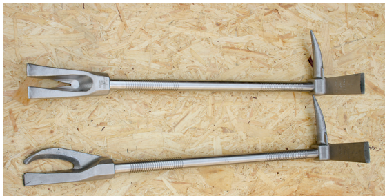
Bild 1: Halligan-Tool mit Hebelklaue (oben) und Halligan-Tool mit Metallschneidklaue (unten) (Foto: Irakli West)
