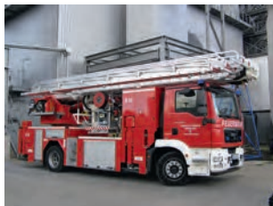
Bild 2: HAB mit Notabstiegsleiter (Fa. Metz/Rosenbauer)
