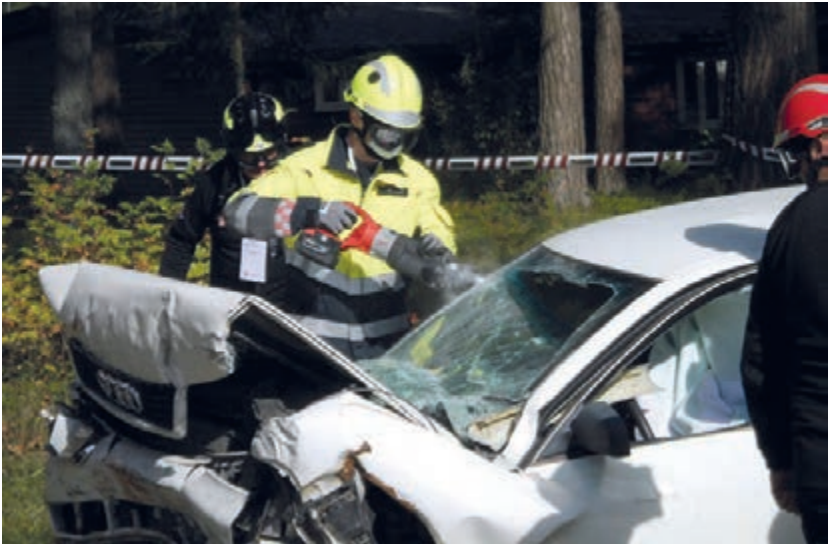
Bild 5 Trennen der Frontscheibe vom Fahrzeugdach mittels Säbelsäge
