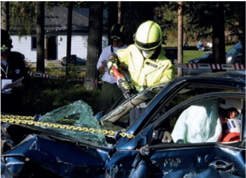
Bild 10 Durchtrennen der A-Säulen mittels Säbelsäge
