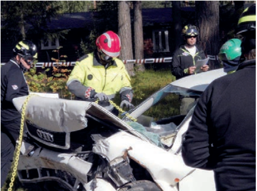
Bild 7 Anschlagen der Ketten an den A-Säulen
