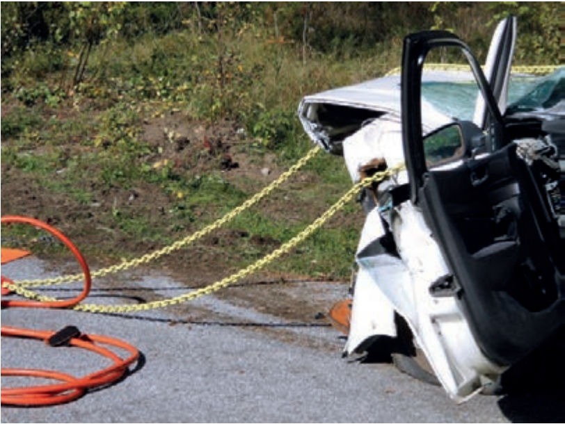
Bild 13 Entspannte Ketten nach dem Zugvorgang
