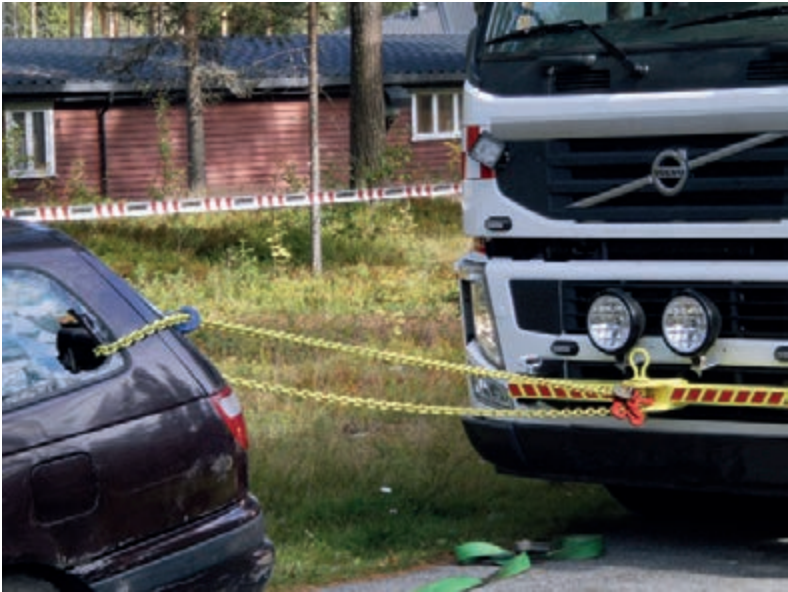
Bild 3 Anschlagen der Kette an der D-Säule eines Kombis. Die Öffnung des Schlinghakens zeigt nach oben.
