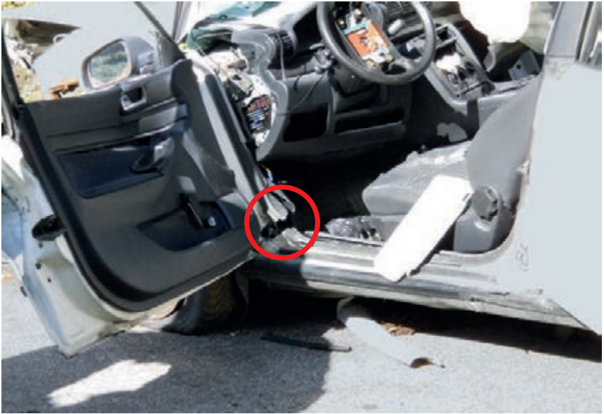
Bild 11 An den Übergängen von der A-Säule zum Schweller werden Entlastungsschnitte gesetzt.
