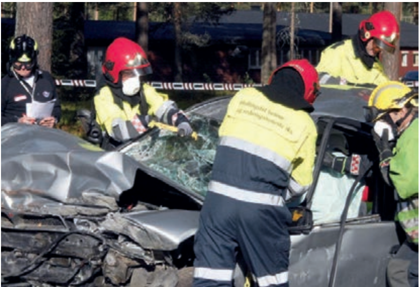
Bild 6 Trennen der Frontscheibe vom Fahrzeugdach mittels Glassäge
