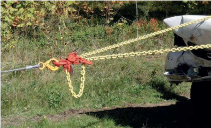
Bild 9 Zum Schutz des Patienten werden die Ketten leicht auf Spannung genommen.
