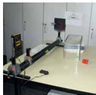
Abb. 13.2: Mit diesem einfachen Experiment beobachten wir den Schatten des verstellbaren Spalts auf der gegenüberliegenden Wand.
