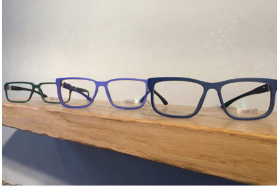
Bild 4.14 Kundenspezifische Brillen; Lasersintern, Polyamid (Quelle: Framelapp)
