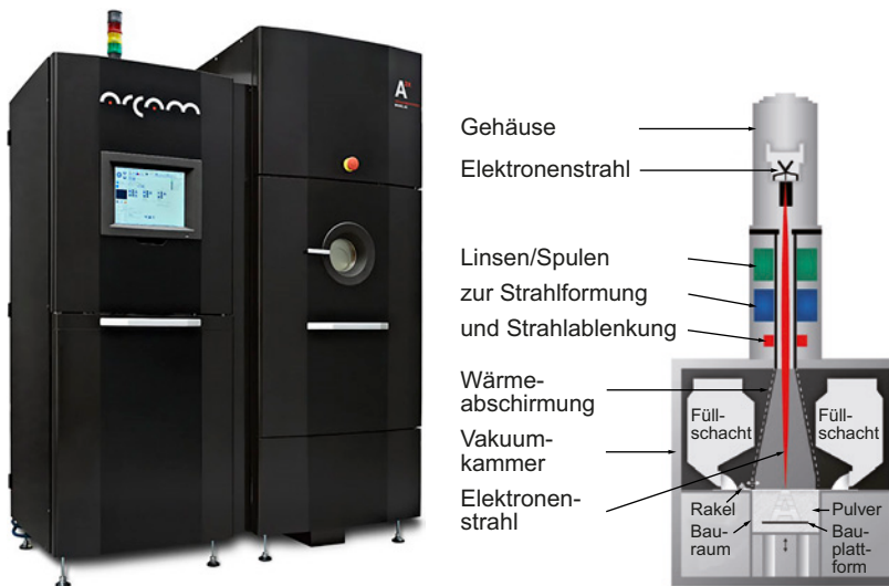
Bild 2.16 Elektronenstrahl-Schmelzen (EBM): ARCAM A2X (links), EBM Funktionsschema (rechts) (Quelle: ARCAM)
