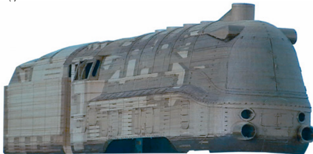
Bild 4.18 Modell einer Spielzeug-Dampflokomotive Maßstab G (1 : 22,5), Laminated Object Manufacturing (LOM); Papier; Nachbehandlung mittels Lasur, ansonsten unbearbeitet (Quelle: CP-GmbH)
