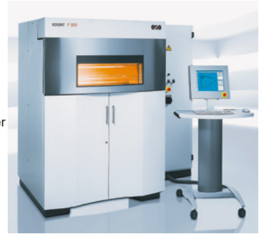
Bild 2.12 Prinzipieller Aufbau einer Sinteranlage von 3D-Systemen (links), Lasersinter Maschine EOSINT P 800 (rechts) (Quelle EOS GmbH)
