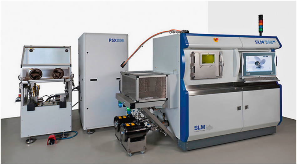
Bild 3.13 SLM® 500 HL Laserschmelzanlage mit Auspackstation PRS (links im Bild) und Pulversiebstation (in der Mitte des Bildes) (Quelle: SLM Solutions)
