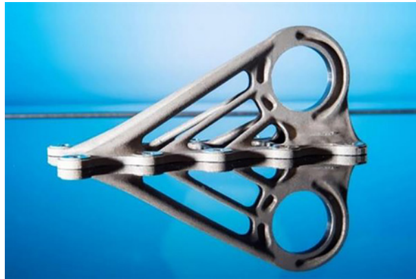
Bild 4.9 3D gedrucktes Bracket wird an Bord des A350XWB eingesetzt, SLM – Titan (Quelle: Airbus)
