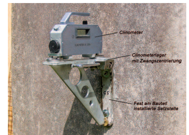
Abb. 4: Clinometermessstelle mit fest am Bauteil installierter Setzstelle
