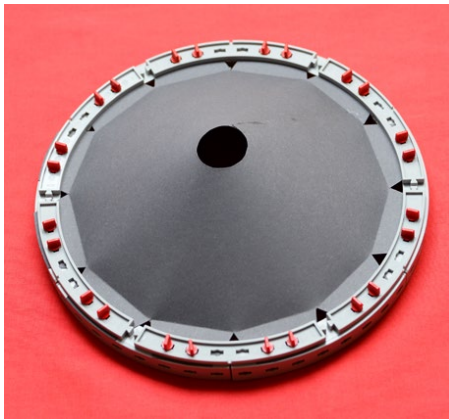
Abb. 1.4.3: Herstellung Lautsprechermembran, Schritt 3: Einbau in fischertechnik-60°-Bogenteile, Rückansicht
