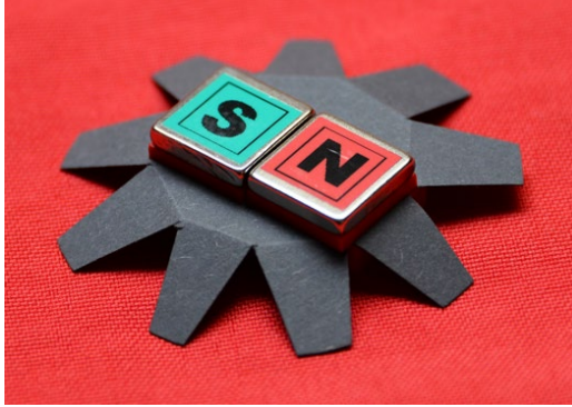
Abb. 1.4.5: Herstellung Lautsprechermembran, Schritt 4: Vorbereitung Magnetplatte, Rückansicht
