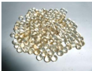
Abb. 2: Füllmaterialien für die Destillations-Kolonnen: Topfreiber, Glaskugeln, Glashohlzylinder
