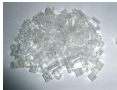
Abb. 2: Füllmaterialien für die Destillations-Kolonnen: Topfreiber, Glaskugeln, Glashohlzylinder
