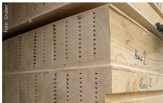
Ein Massivholzsystem aus verleimter Brettstapelbauweise
