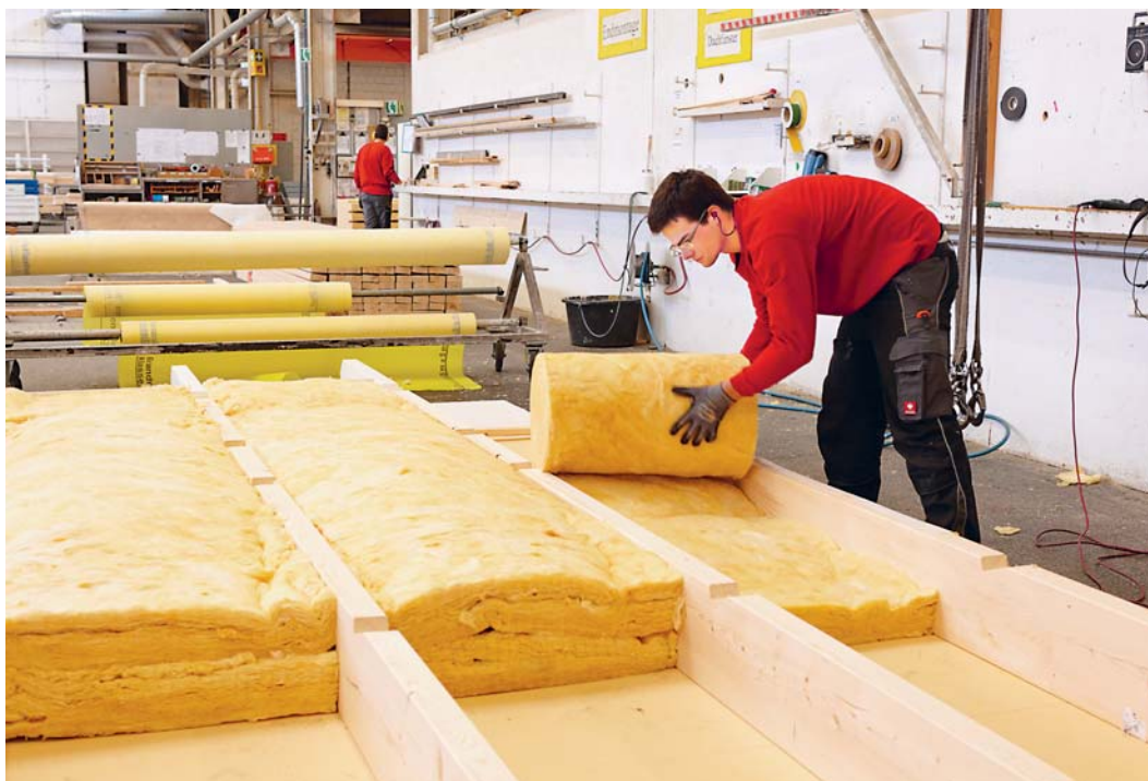
Die Vorfertigung eines Fertighauselements sieht die großzügige Verfüllung nahezu sämtlicher Hohlräume mit Dämmstoffbahnen vor.
