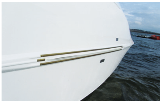
Die Schwertkastenabdichtung ist entscheidend für die Bootsgeschwindigkeit.
