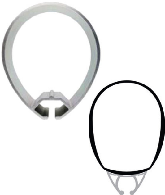
Mastquerschnitt: oben Aluminium, unten Kohlefaser.
