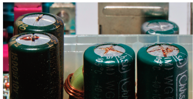
Abb. 12.3: Aufgeblähte minderwertige Kondensatoren
