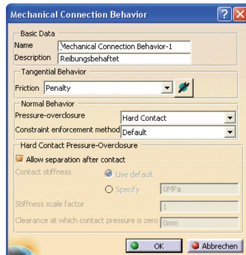
Unter „Friction“ wird in diesem Fall „Penalty“ gewählt, was auch die Eingabe des entsprechenden Reibungskoeffizienten ermöglicht. Dies erfolgt über die Befehlsikone unmittelbar neben dem Auswahlfeld.
