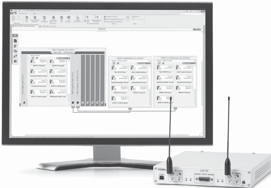
Bild 3: Mit der Plattform LabVIEW Communications Design Suite verfügt der Anwender über eine Entwicklungsumgebung, die angeschlossene Hardware erkennt und komplettiert wird durch Werkzeuge zur Validierung von Systemeinstellungen sowie Implementierung von Algorithmen auf die Hardware.
