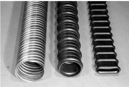
**Bild 14.** Hüllrohre für Spannlieder
