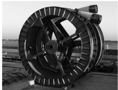
**Bild 9.** Werkmäßig vorgefertigte Spannlieder für nachträglichem Verbund
