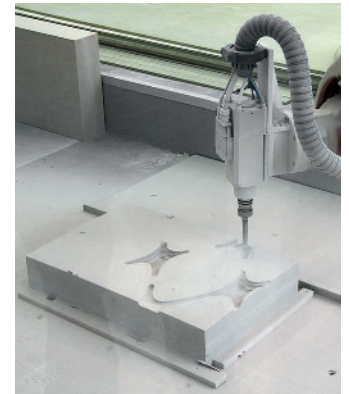
4 Fräsen der Form am ITKE Stuttgart
