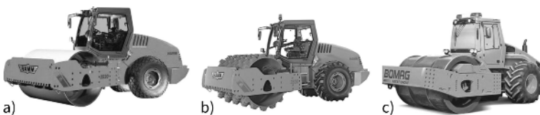
Bild 65 a) Glattmantelbandage [26], b) Stampffußbandage [26], c) Polygonbandage [13] (nach [6])
