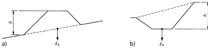
Bild 63 Definition der Untersuchungstiefe z_a und der Bauwerkshöhe h gemäß Eurocode 7 [78]; a) Damm, b) Einschnitt
