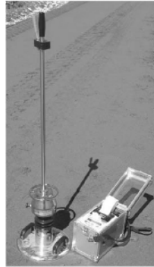
Bild 76 Komponenten des Leichten Fallgewichtsgeräts (nach [1])
