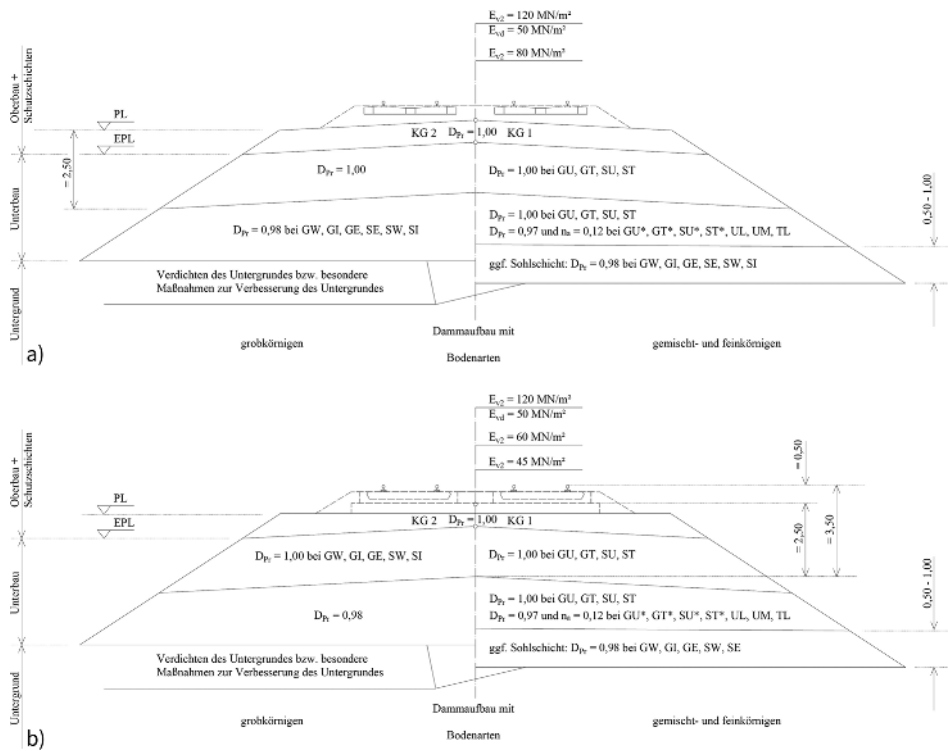
Bild 34 Beispiele von Regelausbildungen des Unterbaus P300 – Damm; a) Schotteroberbau, b) Feste Fahrbahn (nach [46])
