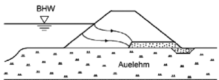
Bild 42 Prinzipskizzen mit Konstruktionsvarianten von Hochwasserdeichen (nach [39])
