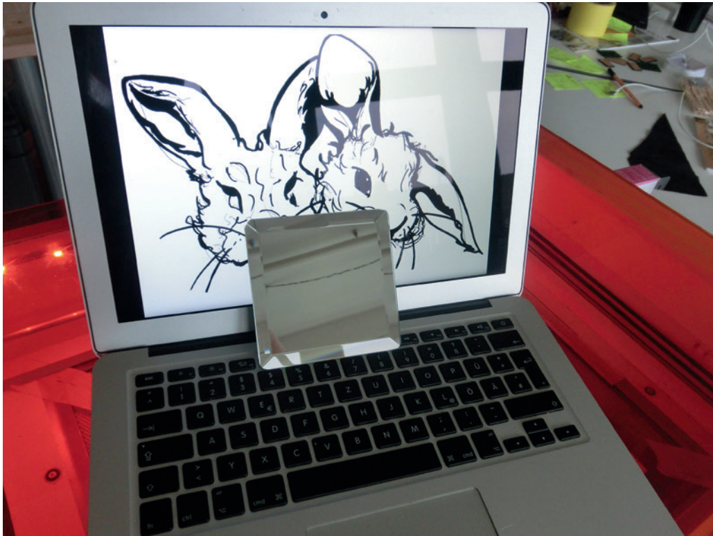
Bild 6.3 Laservorlage und Material für gravierten Spiegeluntersetzer
