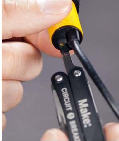
Abb. 3–9 Sie können die Entfernung einstellen, bis zu der der Sensor Hindernisse erkennt.
