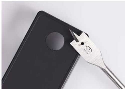
Abb. 3-22 Das Loch für den Infrarotsensor
