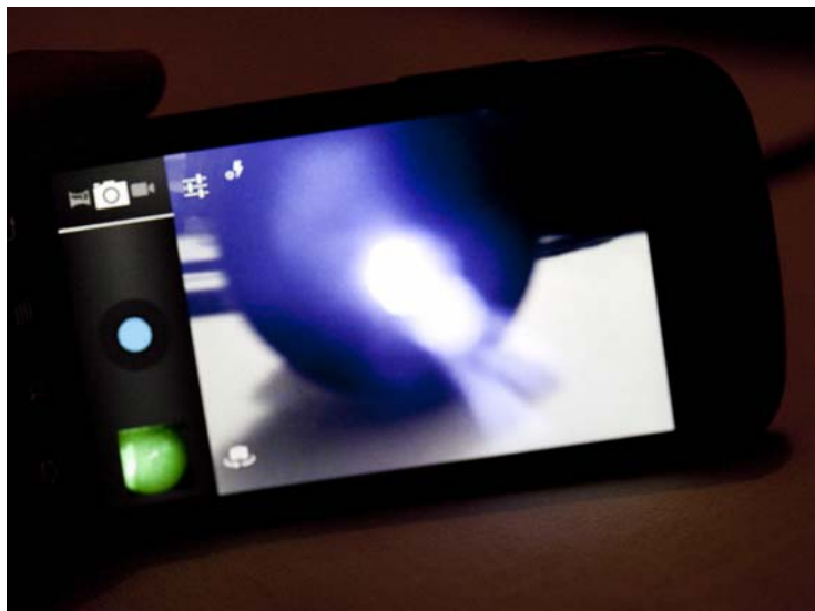
Abb. 3-12 Ein IR-Sensor aus der Sicht einer Handykamera
