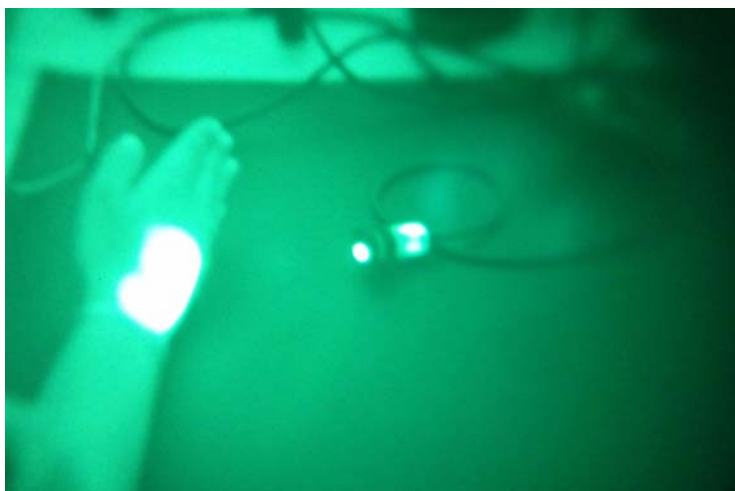
Abb. 3-13 Ein IR-Sensor, betrachtet durch ein Nachtsichtgerät
