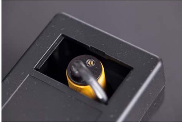
Abb. 3–23 Die Stellschraube für den Abstand können Sie von der Rückseite der Verkleidung aus drehen.
