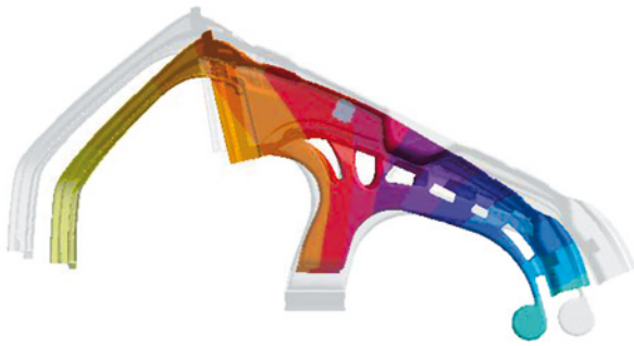
Abb. 1.497: Verzug eines Strukturbauteils in einer Druckgussform. Abhängig von dem Schwindungsverhalten entstehen im erstarrenden und abkühlenden Gussteil plastische (bleibende) Dehnungen, die bei Raumtemperatur zu Verformungen führen (mehrfach überhöhte Darstellung (Flender 2008)).
