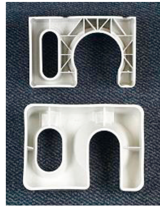
Abb. 4.115: Typisches Formteil mit Verzug entlang der Außenkanten und Korrekturmaßnahmen in den Ecken (oben) (Görich 2007)
