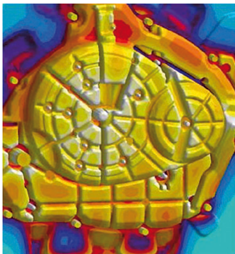
Abb. 1.509: Dauerformverfahren sind nur im quasi-stationären Zustand prozesssicher. Die Simulation berücksichtigt alle wesentlichen Einflussgrößen auf den Wärmehaushalt der Form, wie Kühl- und Heizkreisläufe oder Schichten. Der Einfluss von Prozessstörungen auf die Temperaturen der Form (a) und die Anzahl von Zyklen bis zum Temperaturgleichgewicht (b) kann ganz einfach untersucht werden (Hartmann 2004).
