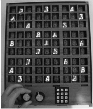
Abb. 1–5 Ein Sudoku aus Nixie-Röhren
