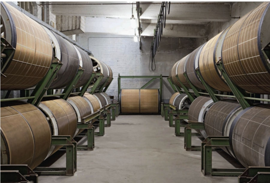
Rundsiebzyylinder für die Herstellung echter Büttenpapiere. Baumwollfasern und Zellstoffe sind die Papierrohstoffe.
