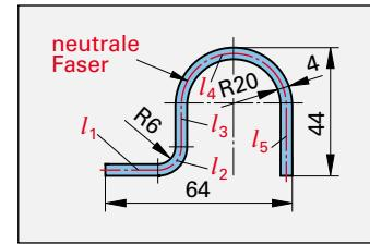
$$l_3 = 44 \text{ mm} - 20 \text{ mm} - 4 \text{ mm} - 6 \text{ mm} - 2 \text{ mm} = 12 \text{ mm}$$
