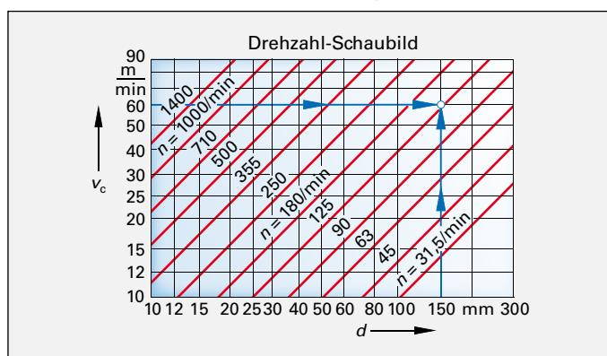
Man geht vom  $v_c$ -Wert waagrecht und vom  $d$ -Wert senkrecht bis zum Schnittpunkt der Hilfslinien. Dort liest man die Drehzahl auf der Drehzahllinie ab.
