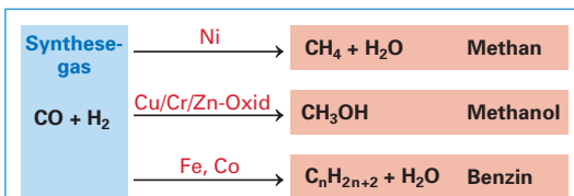
Bild 2: Aus Synthesegas entstehende Produkte bei unterschiedlichen Katalysatoren
