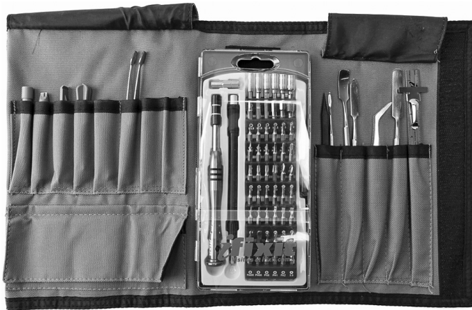
Abb. 1.10: Der iFixit-Werkzeugsatz des Autors. Rechts sind einige Spudger erkennbar.
