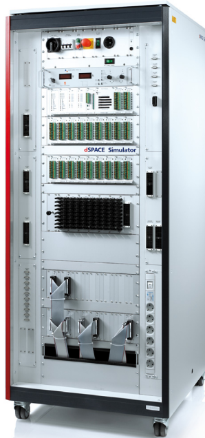
Abb. 1–2 Beispiel einer Testumgebung. Diese Ausrüstung wird verwendet, um Software für Steuergeräte automatisiert zu testen. Produziert die Testumgebung, wie hier, auch alle Stimuli für Sensoren und prüft sie die Funktion von Aktoren, so spricht man vom Hardware-In-The-Loop-Test . Foto © dSPACE GmbH.
