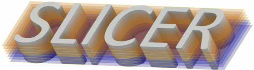
Abb. 1–7 Zerlegung eines 3D-Objekts (Schriftzug) in Scheiben
