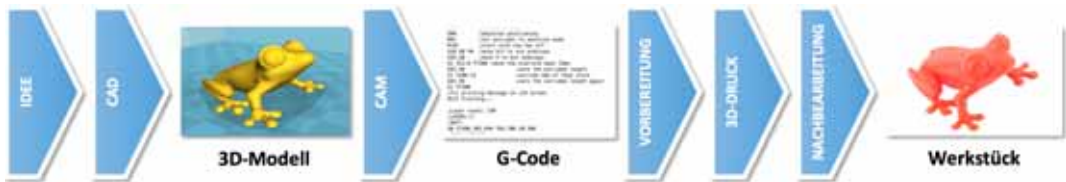
Abb. 1–11 Druckprozess von der Idee zum fertigen Werkstück
