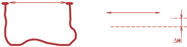
Bild 6.2 Prinzip der kommunizierenden Röhren, Schlauchwaage
