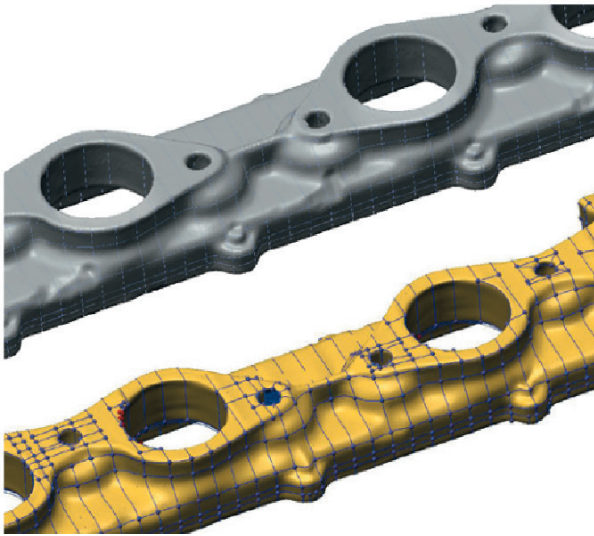
Bild 2.31 Für die Gewinnung von NURBS-Flächen lassen sich Schnitte auf das Polygon legen. Nach dem Export der Schnitte als Kurve, erzeugt PolyWorks zwischen ihren Schnittpunkten Flächen-Patches – die Basis für das spätere CAD (mit freundlicher Genehmigung von Duwe-3D AG).
