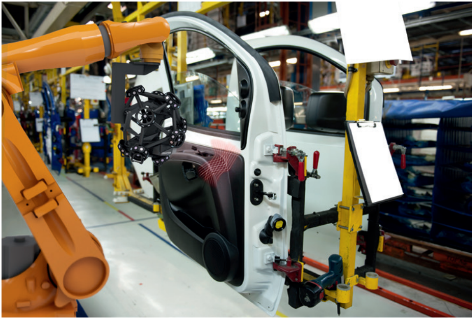
Bild 2.24 Robotergeführter MetraSCAN-R-Scanner für automatisierte Inspektionen in der Produktionslinie (mit freundlicher Genehmigung von Creaform)
