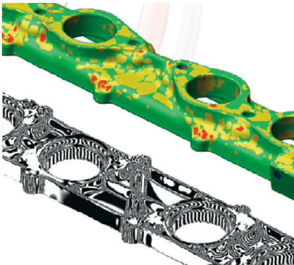
Bild 2.32 Falschfarbendarstellung erleichtert die Beurteilung der NURBS-Flächen (oben), unten: Das Zebromuster zeigt Stetigkeitsbedingungen an, ein gleichmäßiges Muster bedeutet Krümmungsstetigkeit der NURBS-Flächen (mit freundlicher Genehmigung von Duwe-3D AG).
