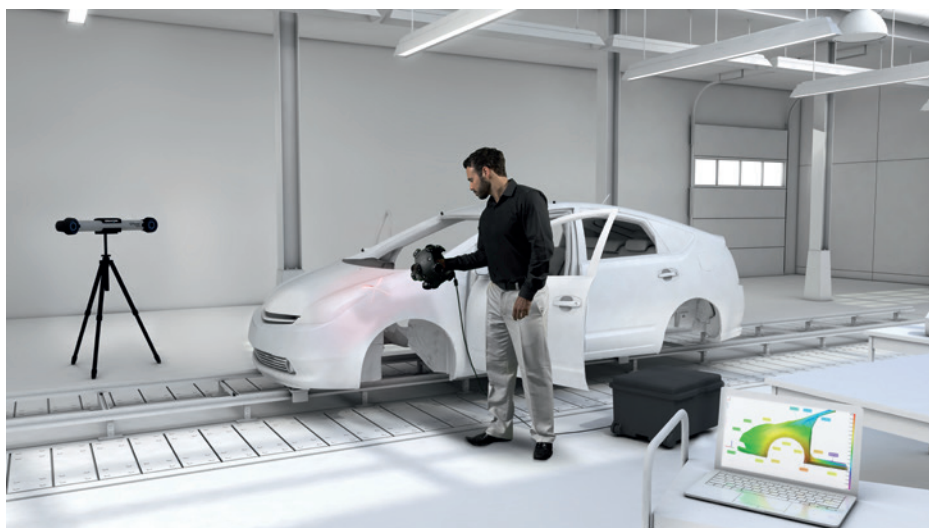
Bild 2.28 3D-Scan einer Karosserie mit dem MetraSCAN 3D (mit freundlicher Genehmigung von Creaform)
