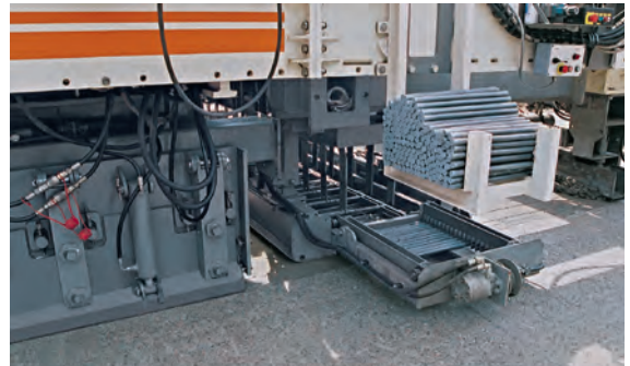
Einrütteln der Dübel mit dem Fertiger
