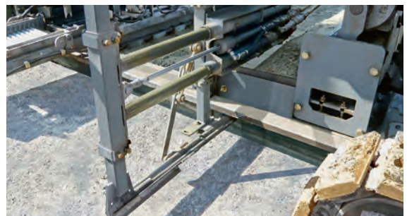
Seitliches Einstoßen der Anker in die Betondecke mit dem Seiteneinstoßgerät
