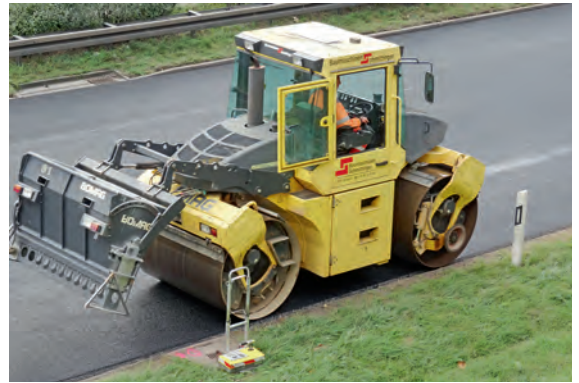
Schemelgelenkte Tandemwalze mit Splittstreuer
