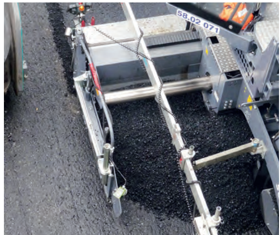
Einbaubohle des Fertigers
