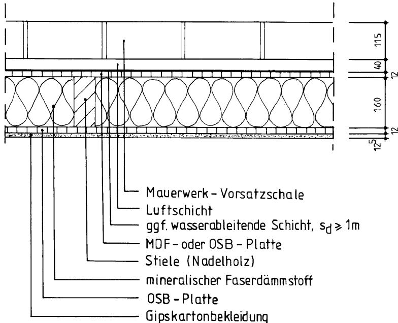
Außenwand in Holzrahmenbauweise mit Mauerwerk-Vorsatzschale, Rastermaß (Stiel-abstand) 62,5 cm.
