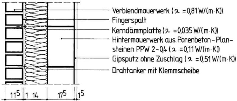
Außenwand aus zweischaligem Mauerwerk mit Kerndämmung, es sind 7 Drahtanker  $\varnothing 4 \text{ mm}$  pro  $\text{m}^2$  aus nichtrostendem Stahl vorgesehen.
