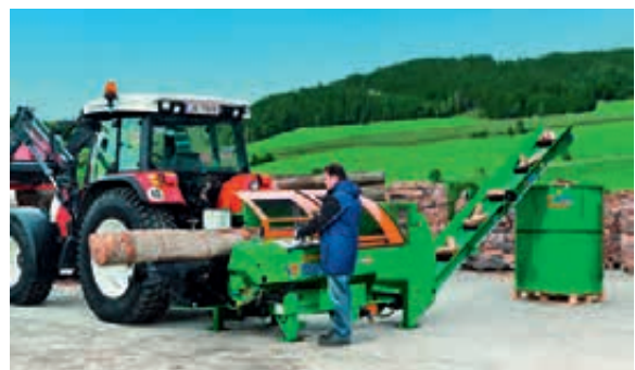
Abb. 2 Sägespalter Posch Typ SpaltFix S-360, bis 12 t Spaltkraft, max. Stammdurchmesser 350 mm
