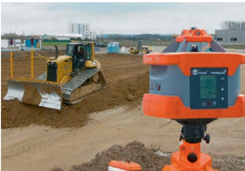
Abb. 3 Ein Standardlaser rotiert bis zu 900-mal/Minute und strahlt einen konstanten Laserstrahl aus; bei jeder Umdrehung legt er die Referenzebene als eine horizontale oder geneigte Ebene fest; der an der Maschine angebrachte Laserempfänger erfasst den Strahl und legt die entsprechende Schildreferenz fest
