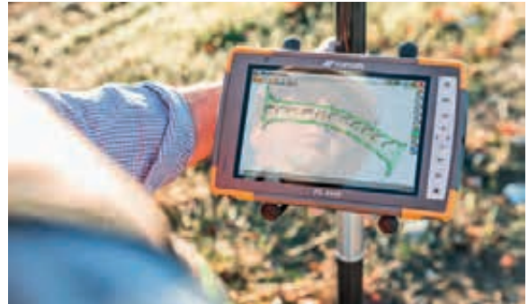
Abb. 2 Robuster Feldrechner empfängt kabellos die Messdaten; u. a. mit Touchscreen, zwei integrierten Digitalkameras und Windows 10
