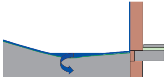
Bild 16. Gefälle zum Gebäude ist möglichst zu vermeiden. Auf Bergseiten kann ein Gegengefälle, gegebenenfalls mit Seitenneigung, von der Bergseite kommendes Wasser um das Gebäude umleiten.
