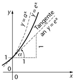
Diejenige dieser Kurven, welche in diesem Punkt die Steigung  $45^\circ$  ( $\tan \alpha^1 = 1$ ) hat, gibt abgeleitet dieselbe Kurve. Die Konstante  $a$  wird in diesem Falle  $e$  (Euler'sche Zahl) genannt und ist die Basis der natürlichen Logarithmen.
