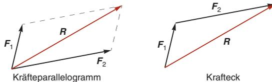
Bild 1.7 Parallelogrammaxiom
