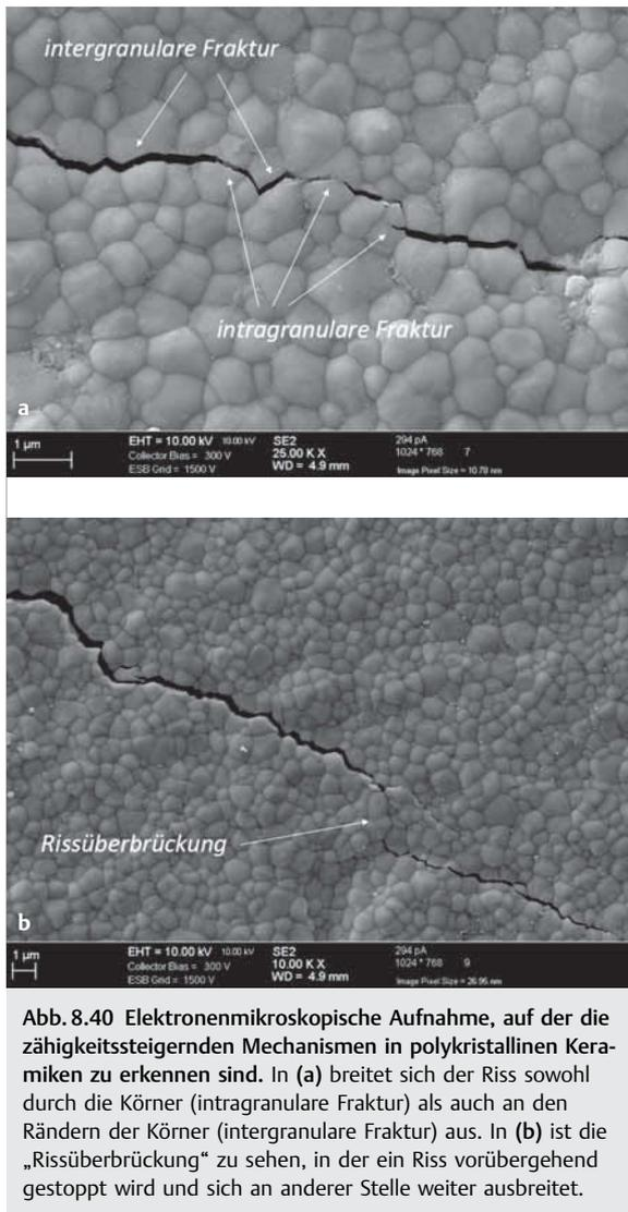
**Abb. 8.40** Elektronenmikroskopische Aufnahme, auf der die zähigkeitssteigernden Mechanismen in polykristallinen Keramiken zu erkennen sind. In (a) breitet sich der Riss sowohl durch die Körner (intragranulare Fraktur) als auch an den Rändern der Körner (intergranulare Fraktur) aus. In (b) ist die „Rissüberbrückung“ zu sehen, in der ein Riss vorübergehend gestoppt wird und sich an anderer Stelle weiter ausbreitet.
