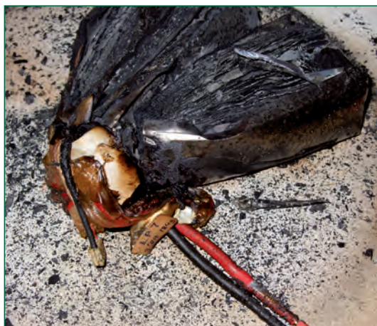
Bild 1: Reste eines Lithium-Polymer-Akkus nach einem „Thermal Runaway“
