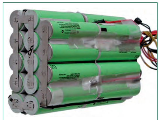
Bild 1: Pedelec-Akku aus 28 Zellen (7s4p)
