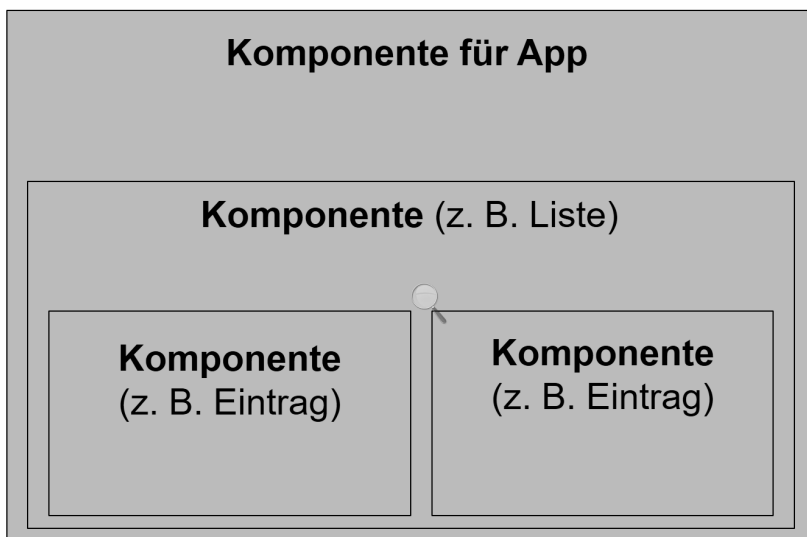
Abbildung 4-2: Hierarchische Struktur einer Angular-Anwendung
