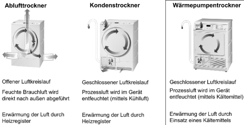
Abb. 1.32 Funktionaler Aufbau von Wäschetrocknern (Quelle: Miele & Cie. KG).
