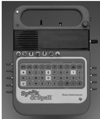
Abbildung 1.5: Ein vom Modified Toy Orchestra modifizierter Speak & Spell nach dem Circuit Bending (mit freundlicher Genehmigung von Modified Toy Orchestra)
