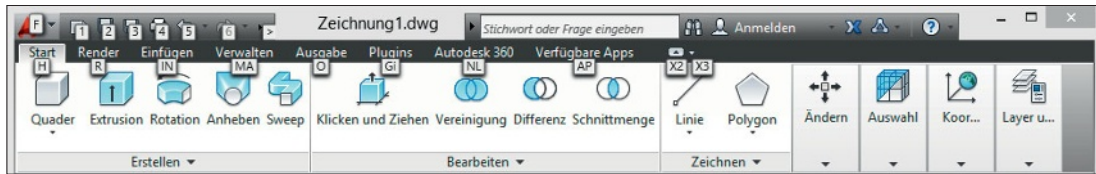
1.12 Mithilfe der Buchstaben und Zahlen können Sie die Multifunktionsleiste über die Tastatur bedienen.
