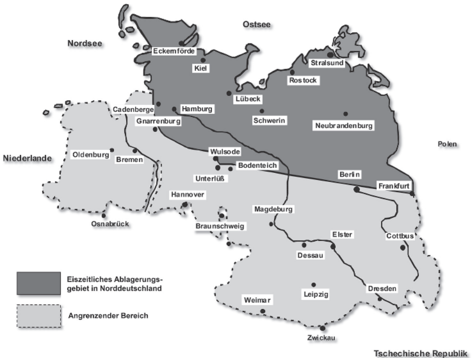
Bild 3. Eiszeitliches Ablagerungsgebiet in Norddeutschland und angrenzender Bereich – fragliche Gesteine im Anwendungsgebiet der Alkali-Richtlinie [2.13]
