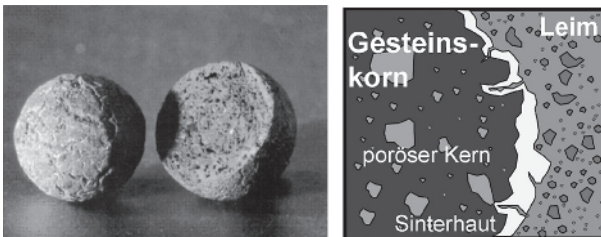
Bild 34. Leichtzuschlagkorn in Ansicht (links) (Quelle: Liapor) und schematischer Querschnitt des Korns, eingebettet in Zementleim (rechts)
