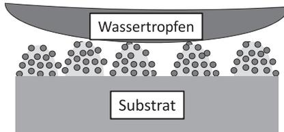
**Abb. 1.6** Der Lotuseffekt. Die Skizze zeigt einen Wassertropfen auf einer doppelt gewellten Oberfläche. Da das Wasser wegen seiner Oberflächenspannung nicht in die Räume zwischen den Papillen eindringen kann, vermittelt diese Anordnung den Ein-
