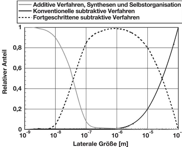
**Abb. 1.4** Geschätzte Größenbereiche, in denen additive und subtraktive Verfahren mit Vorteil angewandt werden. Neue, fortschrittliche subtraktive Verfahren sind aber längst in Größenbereiche vorgedrungen, die typisch für additive Prozesse waren.
