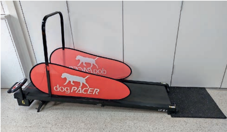
Abb. 4-1 Eine rutschfeste und stoßdämmende Matte hinter dem Trockenlaufband erleichtert das Aufsteigen auf das Band und mildert ein Herabstolpern ab.
