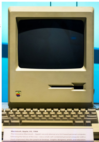
Abb. 5.3 | Der Apple Macintosh 128K von 1984 eröffnete mit seiner grafischen Benutzeroberfläche die Türen zur Gestaltung am Personal Computer (128K steht für 128 Kilobyte Arbeitsspeicher).
