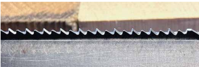
Bereit zum Feilen. Sehen Sie die Abflachungen?
