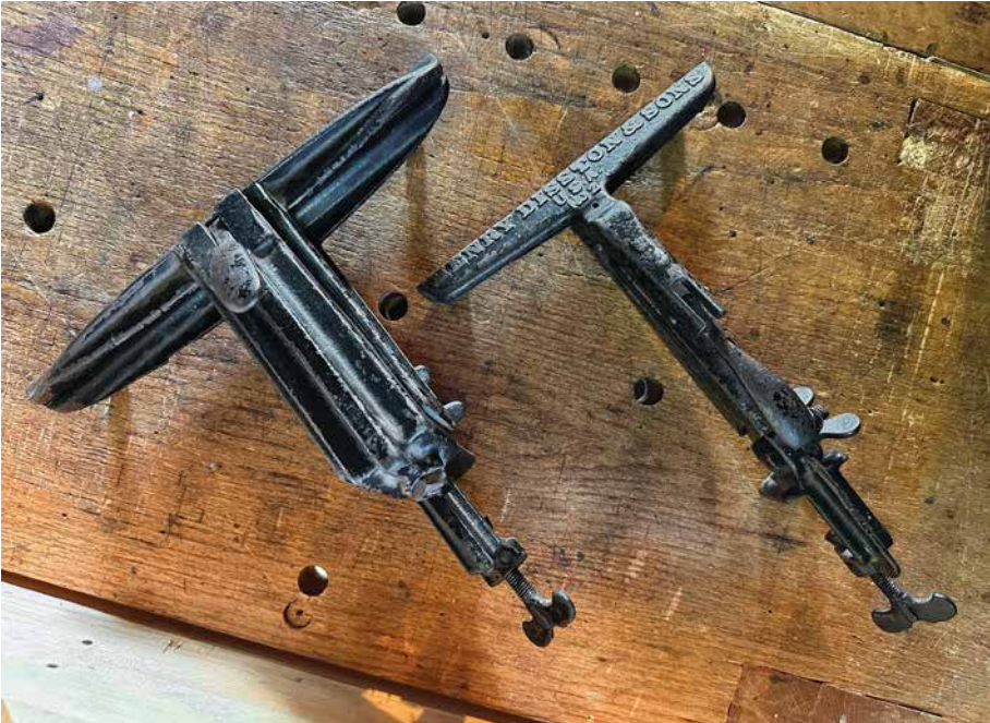
Die D3-Feilkuppe von Disston links ist noch gut in Schuss. Die Disston Nr. 2 rechts? Nicht so ganz.
