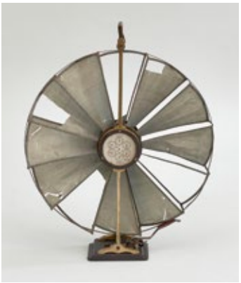
◀ Abb. 25 Anemometer vom Windbergschacht Gruten/Elberfeld, um 1870, III/79/201/G
