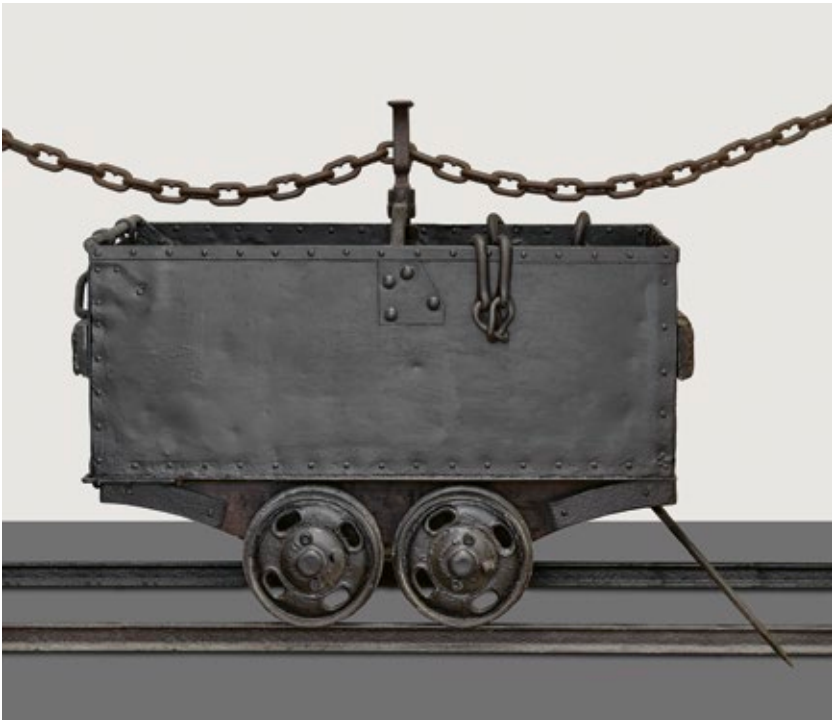
Abb. 24 Hunt zur kettengeführten Förderung um 1935, III/79/331/G
